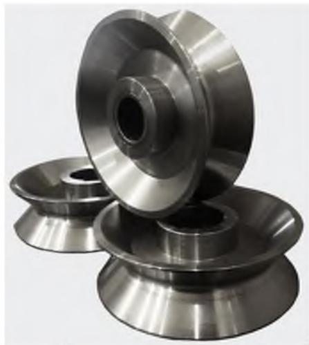
Универсальная оснастка для трубогибной машины 3-х роликовой (вальцевой) гибки состоит из 3-х универсальных стальных роликов с ручьем под любую круглую трубу до 30 мм
