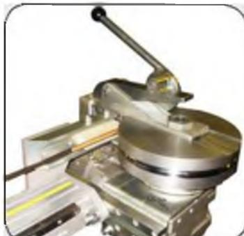
Высокотехнологичные элементы оснастки позволяют получать качественные гибы на тонкостенных трубах при минимальном радиусе гиба
