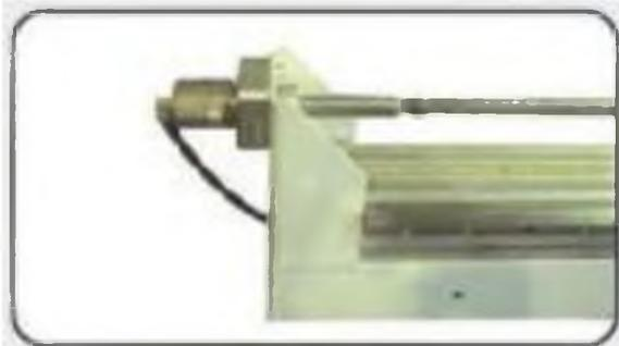
**Ручная каретка** (для контроля поворота трубы в пространстве и линейного выдвижения трубы в точку начала очередногогиба)
