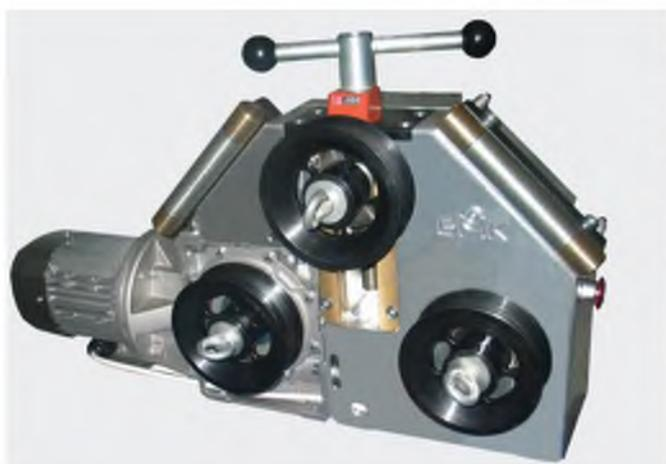
Для изготовления колец, сегментных дуг и спиралей с заданным шагом подъема витка методом холодной вальцовки гибки труб
