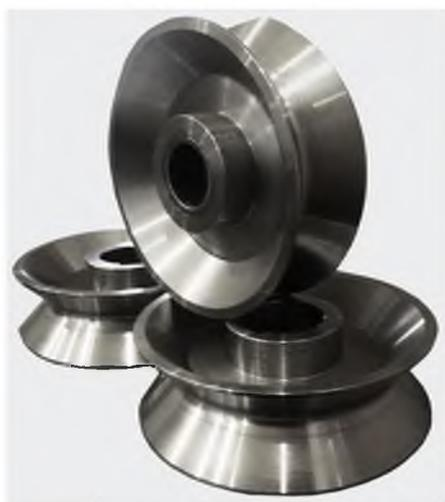
Универсальная оснастка для трубогибочной машины 3-х роликовой (вальцевой) гибки состоит из 3-х универсальных стальных роликов с ручьем под любую круглую трубу до 35 мм
